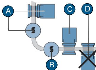
Монтажное положение **(C)**: разрешено при следующих условиях.
